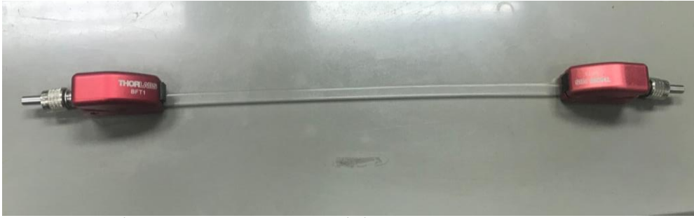
รูปที่ 2.3 เส้นใยนำแสงพลาสติกที่เชื่อมกับ bare fiber terminator
