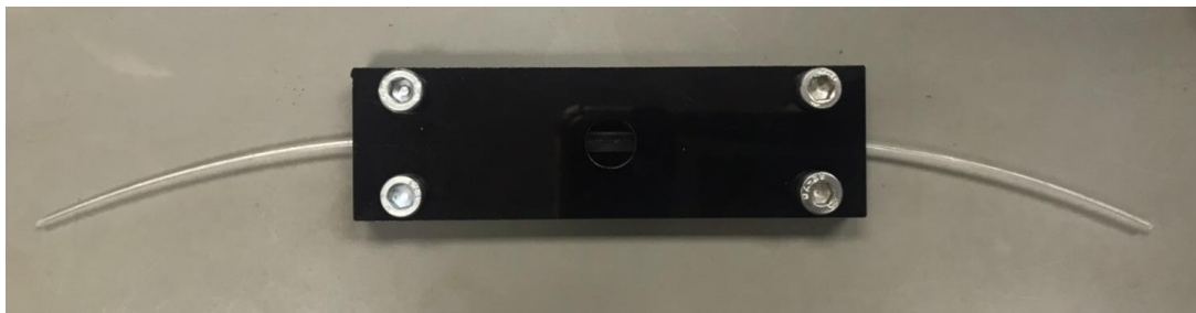
รูปที่ 2.6 เส้นใยนำแสงพลาสติกที่ถูกประกอบเข้ากับอุปกรณ์ที่นำมาใช้ทดสอบคุณสมบัติเชิงแสงของเส้นใยนำแสงพลาสติก
