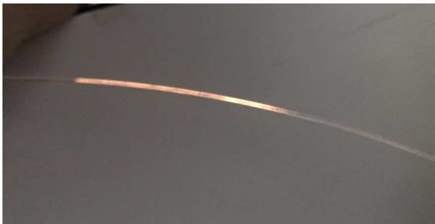
รูปที่ 3.6 แสงที่ผ่านบริเวณที่ลอกฟิล์มหุ้มของวิธีที่ 2
