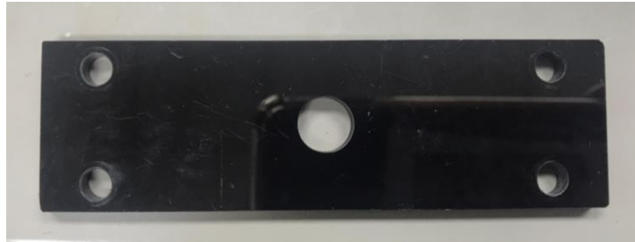
รูปที่ 2.5 ส่วนบนของอุปกรณ์ที่นำมาใช้ใส่ของเหลวและเส้นใยนำแสงพลาสติก
