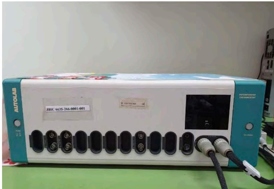
รูปที่ 3.4 เครื่องทดสอบสมบัติทางไฟฟ้าเคมี Autolab Potentiostat/Galvanostat รุ่น PGSTAT-30 ยี่ห้อ Metrohm Autolab
