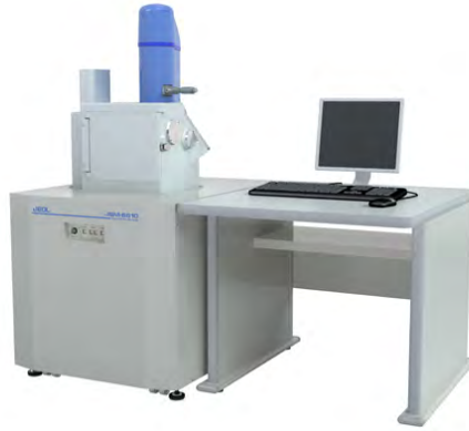
รูปที่ 3.2 กล้องจุลทรรศน์อิเล็กตรอนแบบส่องกราด รุ่น JEOL JSM-6610LV
