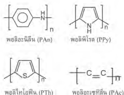
รูปที่ 2.9 โครงสร้างทางเคมีของพอลิเมอร์นำไฟฟ้าบางชนิด (ในรูปที่ยังไม่โด๊ป) [4]
