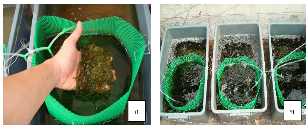
รูปที่ 3.6 การบรรจุสาหร่ายช่อพริกไทยในตาข่ายพลาสติกภายในถังทดลอง (ก) และตัวอย่างถังทดลองที่มีสาหร่ายในตาข่ายพลาสติก (ข)
