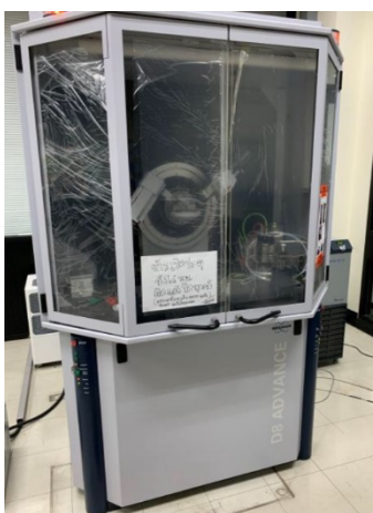
รูปที่ 3.7 เครื่องวิเคราะห์การเลี้ยวเบนรังสีเอกซ์ (X-Ray Diffraction, XRD)
