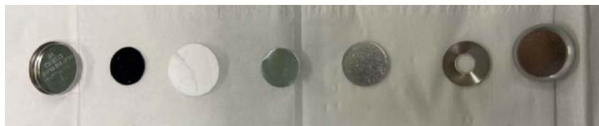
รูปที่ 3.13 ส่วนประกอบของแบตเตอรี่สังกะสี-ไอออนชนิดเซลล์เหรียญ
