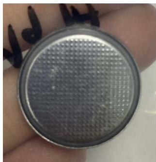
รูปที่ 3.16 แบตเตอรี่ชนิดสังกะสี-ไอออนในรูปแบบเซลล์เหรียญ
