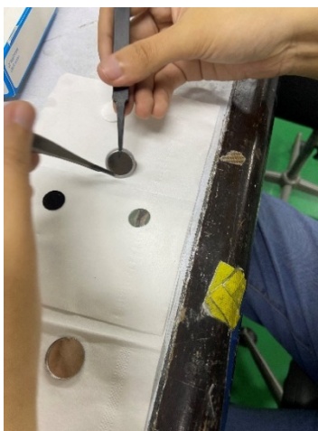
รูปที่ 3.14 การประกอบของแบตเตอรี่ชนิดสังกะสี-ไอออนในรูปแบบเซลล์เหรียญ
