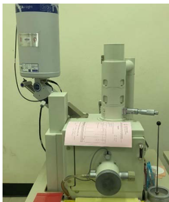
รูปที่ 3.6 กล้องจุลทรรศน์อิเล็กตรอน (Scanning Electron Microscope, SEM) และเครื่องวิเคราะห์ธาตุด้าน X-Ray (Energy Dispersive X-Ray Spectroscopy, EDS)
