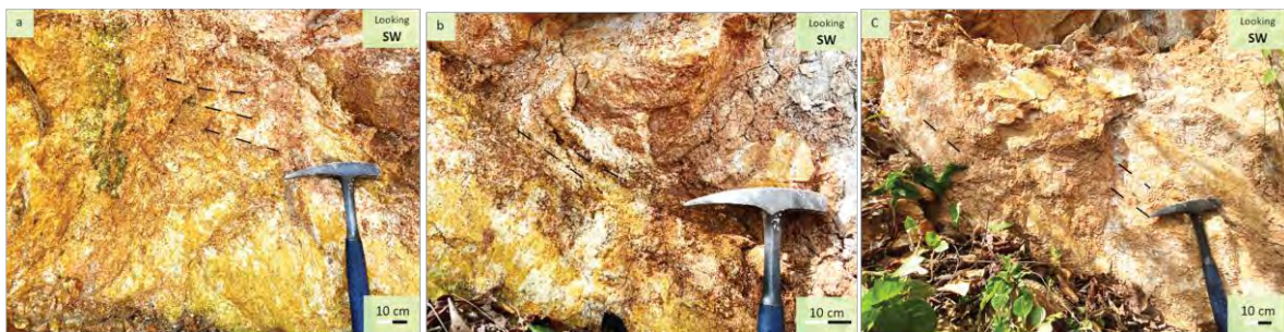
รูปที่ 4.5 รูป a, b, และ c แสดงระนาบการเลื่อนตัวในตะกอนที่มีค่าเฉลี่ยประมาณ 340/80NE และเส้นปะสีดำแสดงลักษณะรอยครูดที่พบในระนาบของรอยเลื่อน
