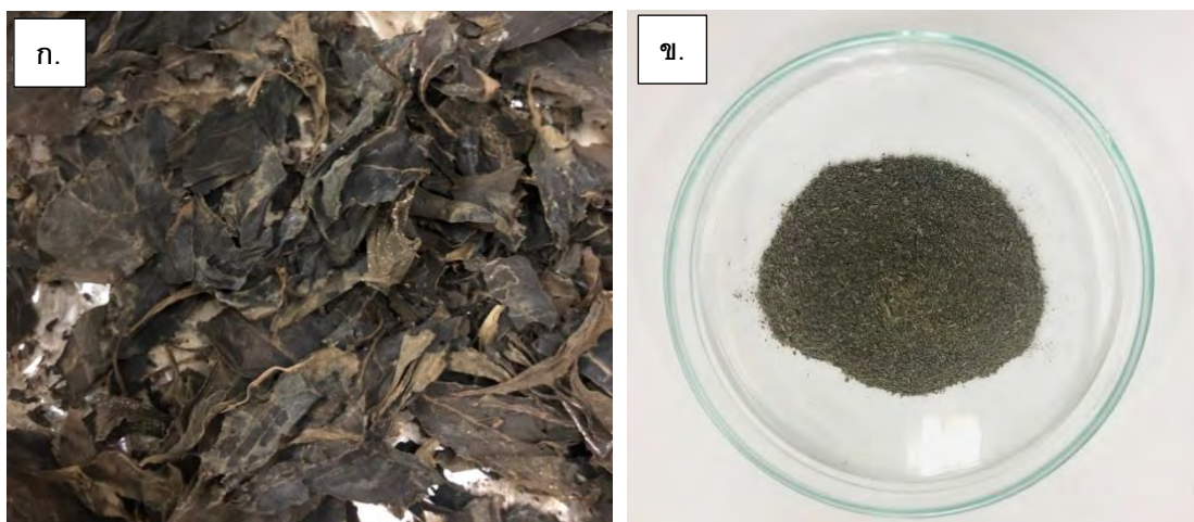
ภาพที่ 6 ตัวอย่างใบแปะตำปิ้งอ่อนแห่งจังหวัดชัยภูมิ ก) ตัวอย่างใบหลังจากอบที่อุณหภูมิ 60 °C ข) ตัวอย่างใบหลังจากนำมาบดด้วยเครื่องปั่น
