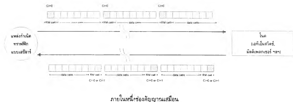
รูปที่ 2.2 การทำงานของระบบควบคุมแบบบีอีซีเอ็น
