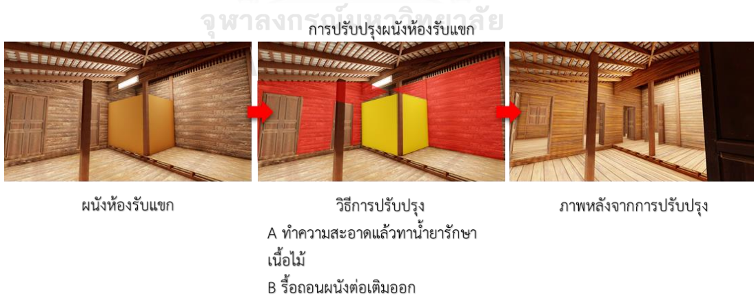
รูปที่ 82 ภาพก่อนและหลังการปรับปรุงผนังห้องโถง
