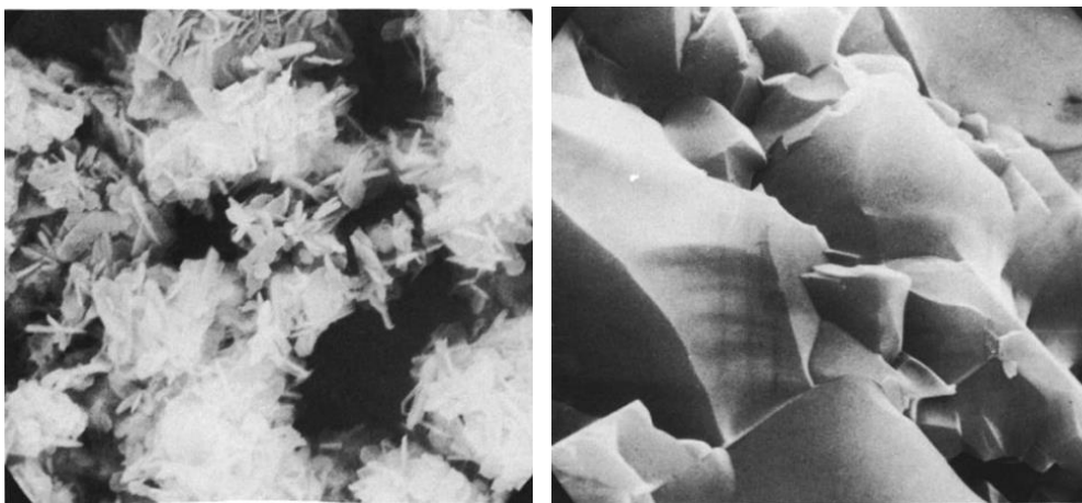
ภาพที่ 2.2 ลักษณะผลึกและพื้นผิวรอยแตกของสปีเนลที่สังเคราะห์โดย Krijgsman [6]
