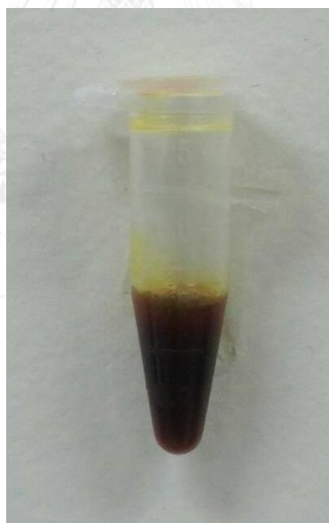
รูปที่ 3.6 ลักษณะของสารลดแรงตึงผิวชีวภาพที่สกัดได้ในรูปของสารสกัดหยาบ
