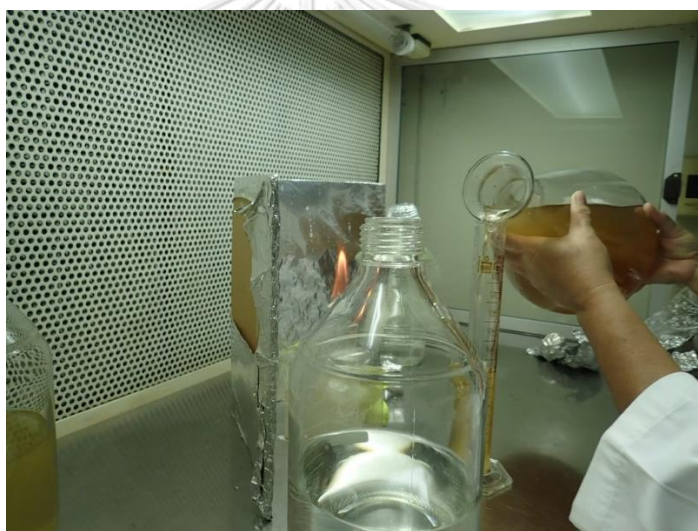
รูปที่ 8 การนำหัวเชื้อ Isochrysis galbana ปริมาตร 100 มิลลิลิตรมาขยายเพาะเลี้ยงในอาหารเลี้ยงแพลงก์ตอนสูตร T 1 ที่ได้ผ่านการนึ่งฆ่าเชื้อที่อุณหภูมิ 121 องศาเซลเซียส เป็นเวลา 20 นาที
