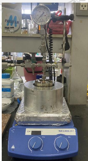
รูปที่ 3.1 เครื่องปฏิกรณ์ทนความดันสูงชนิดกะ รุ่น Parr 4848
