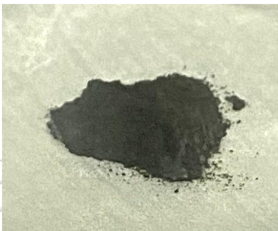
รูปที่ 3.2 ตัวเร่งปฏิกิริยา Ni/SBA-15 ภายหลังจากการเผาที่ 500 องศาเซลเซียส นาน 2 ชั่วโมง
