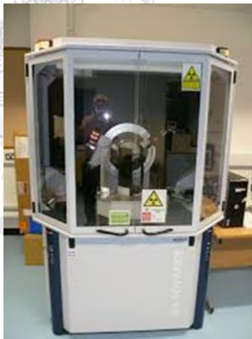
รูปที่ 3.3 เครื่องเอกซเรย์ดิฟแฟรคโทมิเตอร์ ยี่ห้อ Bruker รุ่น D8 Advance
