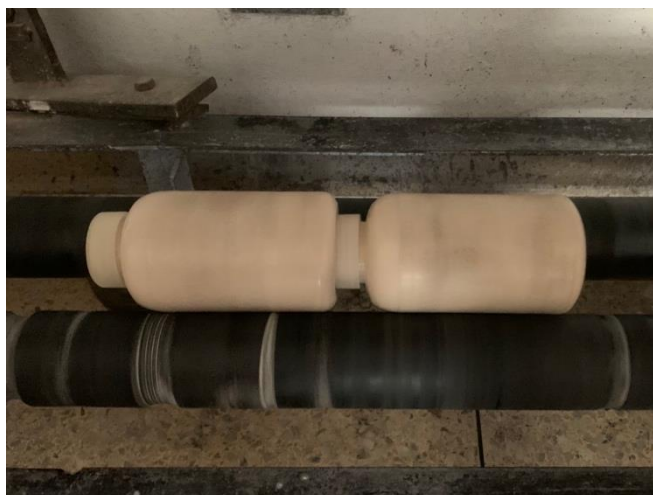
รูปที่ ก.3 เครื่องกลึงบด (Rotary Ball milling)
