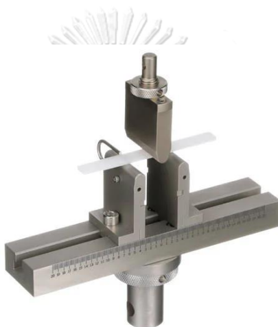
รูปที่ 3.8 เทคนิคการทดสอบความต้านทานแรงดัดด้วยเครื่อง 3-point bending machine [39]
