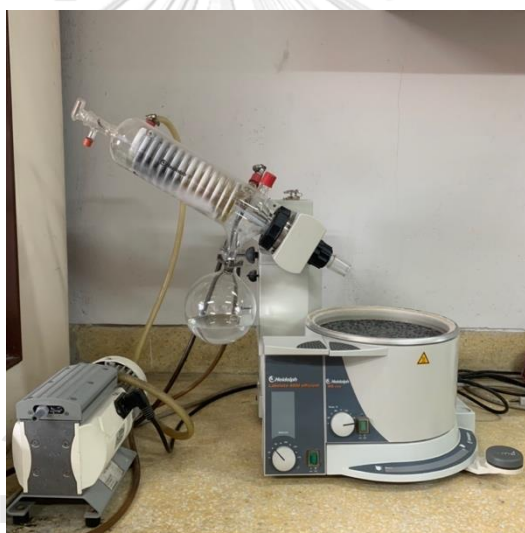
รูปที่ ก.4 เครื่องกลั่นสารระเหยแบบหมุน (Rotary evaporator)
