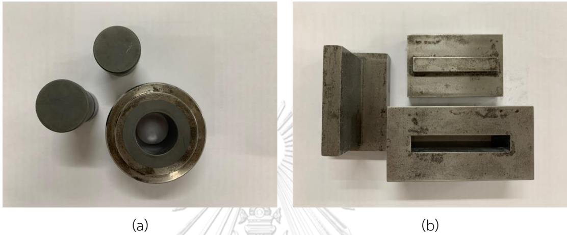
รูปที่ ก.1 แม่พิมพ์ขึ้นรูปด้วยเครื่องอัดไฮดรอลิกแบบทิศทางเดียว (a) ลักษณะทรงกระบอกขนาดเส้นผ่านศูนย์กลาง 20 มิลลิเมตร และ (b) ลักษณะแท่งสี่เหลี่ยมขนาดกว้าง 9.6 มิลลิเมตร ยาว 59.6 มิลลิเมตร
