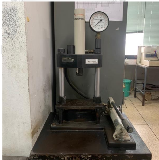
รูปที่ ก.2 เครื่องอัดไฮดรอลิกแบบทิศทางเดียว (Uniaxially hydraulic press)
