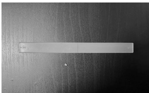
รูปที่ 3.13 ชิ้นทดสอบความทนแรงดัดโค้ง
