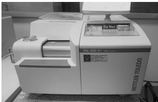
รูปที่ 3.16 เครื่องวิเคราะห์น้ำหนักภายใต้ความร้อนและเครื่องดีฟเฟอเรนเชียลสแกนนิ่งแคลอริมิเตอร์
