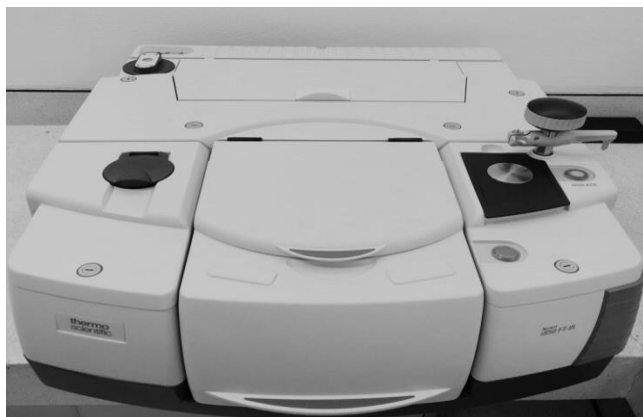
รูปที่ 3.5 เครื่องฟูเรียร์ทรานสฟอร์มอินฟราเรดสเปกโทรมิเตอร์
