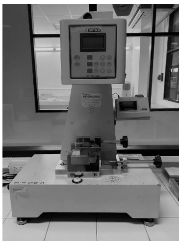
รูปที่ 3.8 เครื่องทดสอบความทนแรงกระแทก
