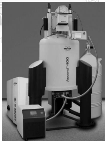
รูปที่ 3.6 เครื่องนิวเคลียร์แมกเนติกเรโซแนนซ์สเปกโทรสโกปี
