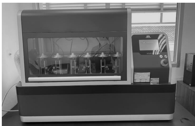
รูปที่ 3.17 เครื่องทดสอบอุณหภูมิการโค้งงอเนื่องจากความร้อนและอุณหภูมิอ่อนตัวด้วยความร้อน
