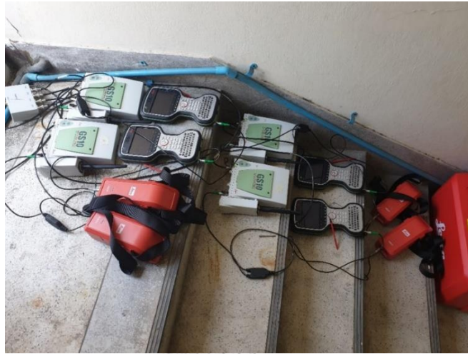
รูปที่ 3.2 สายสัญญาณผ่านสปริตเตอร์ เพื่อแยกสัญญาณดาวเทียมไปยังเครื่อง Receiver จำนวน 4 เครื่อง
