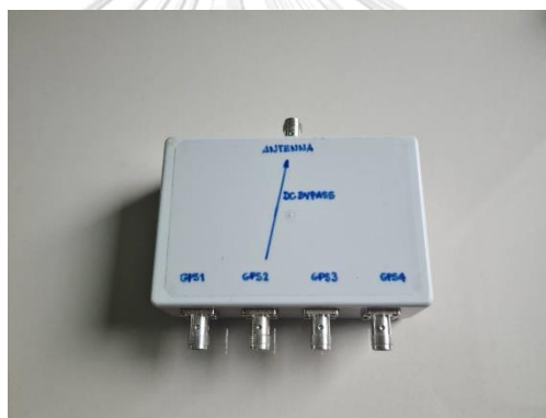
รูปที่ 1.9 เครื่องแยกสัญญาณจาก GNSS (GNSS signal splitter)
