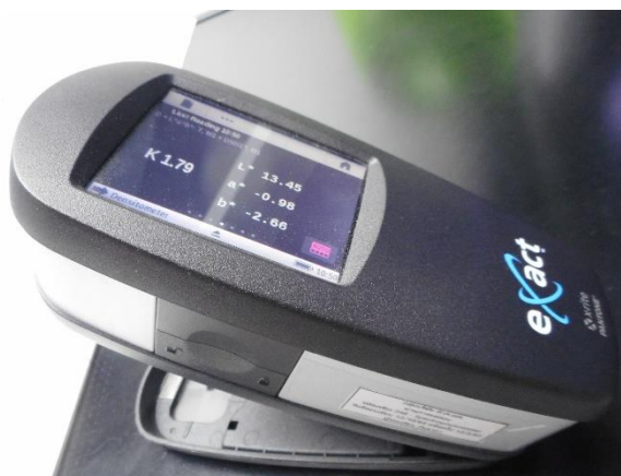
ภาพที่ 4.6 การวัดความหนาแน่นของหมึกตามปริมาณหมึกพิมพ์ที่ปล่อย โดยเครื่อง Spectrophotometer
