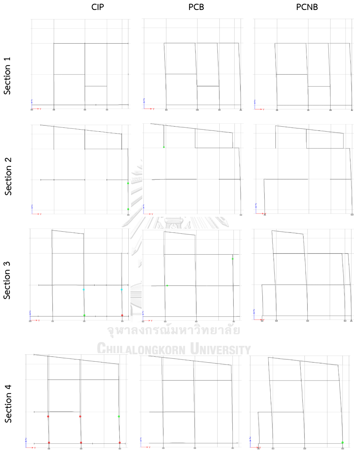
รูปที่ 5.8 ความเสียหายของอาคารตัวอย่างจากการวิเคราะห์วิธีสถิตไม่แข็งเส้นกรณี 1.1PUSH_Y-
