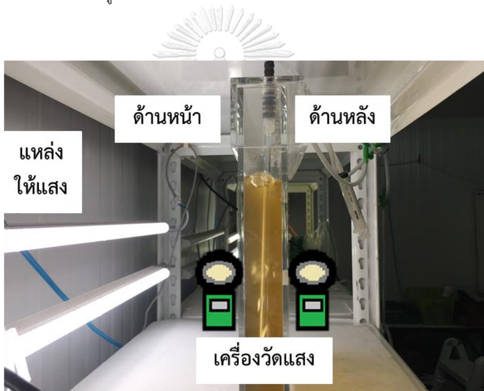
รูปที่ 3.3 การวัดแสงด้านหน้าและด้านหลังของถังปฏิกรณ์ชีวภาพเชิงแสงชนิดแผ่นแบน
