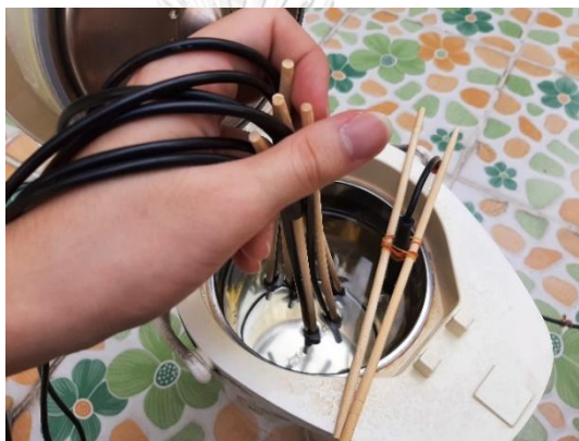
รูปที่ 3-14 การ calibrate อุปกรณ์ในน้ำร้อน
