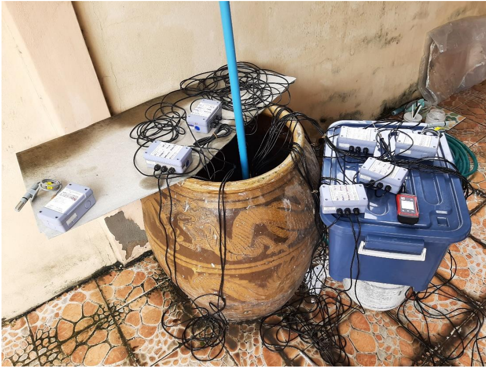
รูปที่ 3-8 การ calibrate อุปกรณ์ในน้ำอุณหภูมิปกติ
