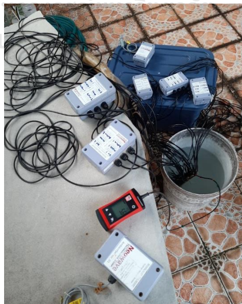
รูปที่ 3-13 การ calibrate อุปกรณ์ในน้ำเย็น
