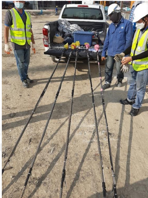
รูปที่ 3-30 เหล็กข้ออ้อยที่มีการติดตั้ง Node และ temperature sensor เรียบร้อยแล้ว
