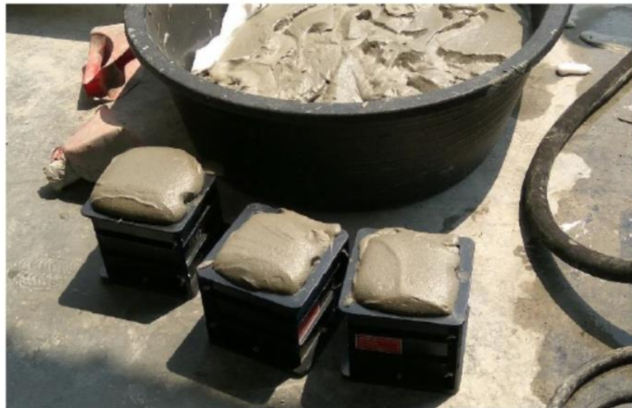
รูปที่ 3-43 การผสมคอนกรีตโฟมความหนาแน่นต่ำมาก (วรากร อิมรักษา, 2562)
