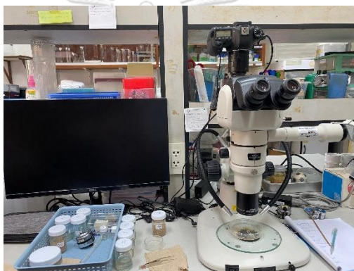
ภาพที่ 5 กล้องจุลทรรศน์ชนิดสเตอริโอไฮ้ท้อ Nikon รุ่น SMZ800N
