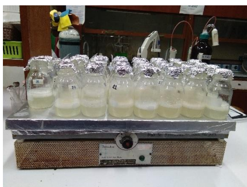
ภาพที่ 3 (ซ้าย) การให้ความร้อนขณะย่อยหอยสองฝาด้วยสารละลายไฮโดรเจนเปอร์ออกไซด์
