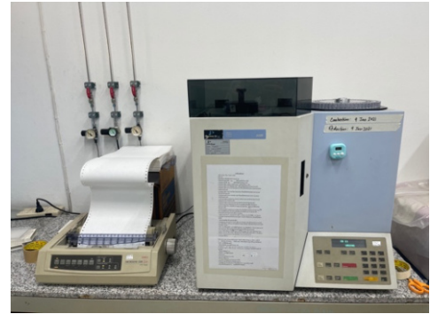
(ค) บรรจุดินตะกอนที่กำจัดสารอินทรีย์แล้ว (ง) เครื่อง CHN/O Analyzer รุ่น PE 2400 Series II ในแคปซูลที่ทำด้วยดีบุก (tin cup)
