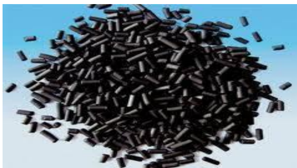
รูปที่ 2.8 แสดงลักษณะถ่านกัมมันต์ชนิดเม็ด (สุวรรณา แจ็กมะดัน, 2554)
