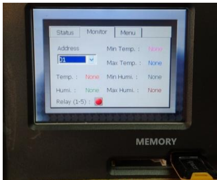
รูปที่ 3.21 เครื่องบันทึกข้อมูลอัตโนมัติ
