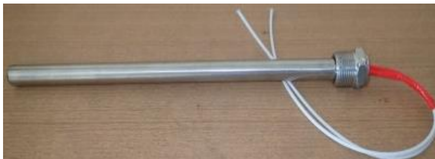
รูปที่ 3.5 เครื่องทำความร้อนด้วยขดลวดไฟฟ้า
