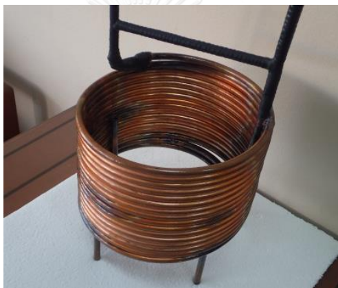
รูปที่ 3.11 เครื่องควบแน่น 1
