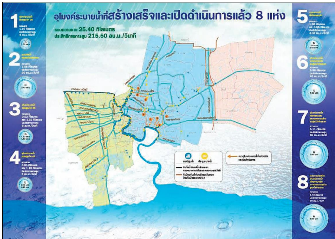
รูปที่ 2.5 อุโมงค์ระบายน้ำที่สร้างเสร็จและเปิดดำเนินการแล้ว 8 แห่ง (ที่มา : สำนักการระบายน้ำ กรุงเทพมหานคร, 2564)
