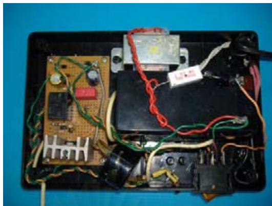
ภาพแสดงแผงวงจรเซนเซอร์เครื่องตรวจจับการไหลของน้ำของปั๊สสาวะ
