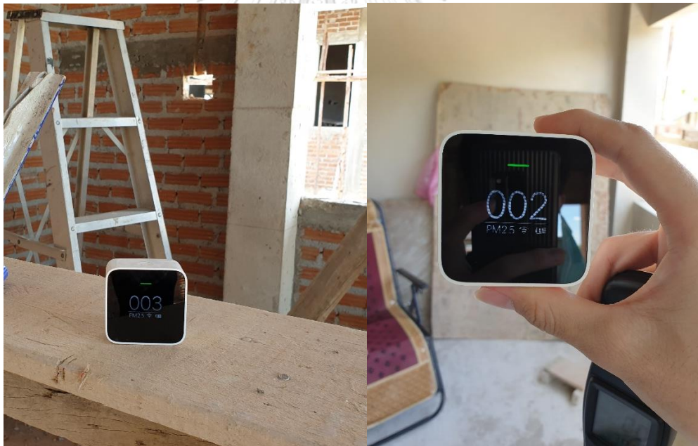
รูปที่ 5.18 รูปภาพแสดงขณะทำการวัดค่าปริมาณฝุ่นละออง PM 2.5 ในสภาพอากาศปกติ โดยรอบโครงการศึกษาระดับที่ 2 โดยใช้เครื่องวัดปริมาณฝุ่นละอองแบบพกพา (Xiaomi Mi Smart Air Quality Monitor PM2.5 Detector)
