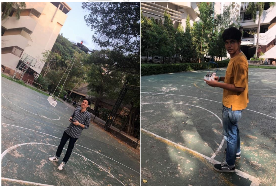
รูปที่ 4.34 รูปภาพแสดงขณะทำการทดลองเปรียบเทียบค่าที่วัดได้จากเซ็นเซอร์ตรวจวัดฝุ่นละออง (PMS 5003) ที่อยู่ในตะกร้าที่ถูกผูกติดอยู่กับอากาศยานไร้คนขับ กับค่าที่วัดได้จากเซ็นเซอร์ตรวจวัดฝุ่นละอองตามปกติเพื่อทดสอบว่าต้องใช้เชือกยาวเท่าใด
