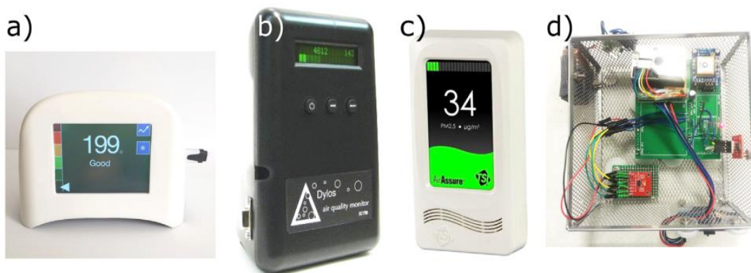
รูปที่ 2.6 รูปภาพแสดงเครื่องมือวัดฝุ่นละอองที่ใช้ศึกษาประกอบด้วย (a) Speck, (b) Dylos 1700, (c) TSI Air Assure และ (d) UBAS (ที่มา: Manikonda, Ziková et al. (2016))
