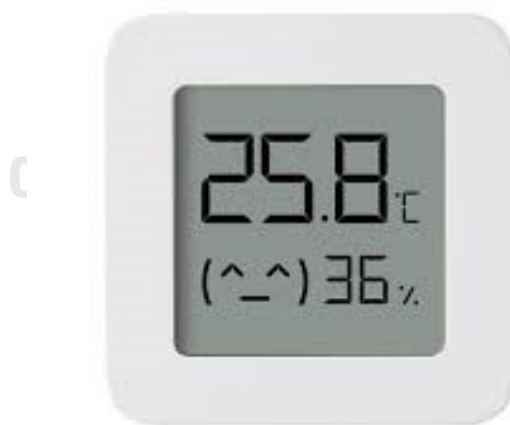
รูปที่ 4.33 รูปภาพแสดงเครื่องวัดอุณหภูมิและความชื้น Xiaomi Mijia Square Temperature and Humidity Sensor Bluetooth 4.2
