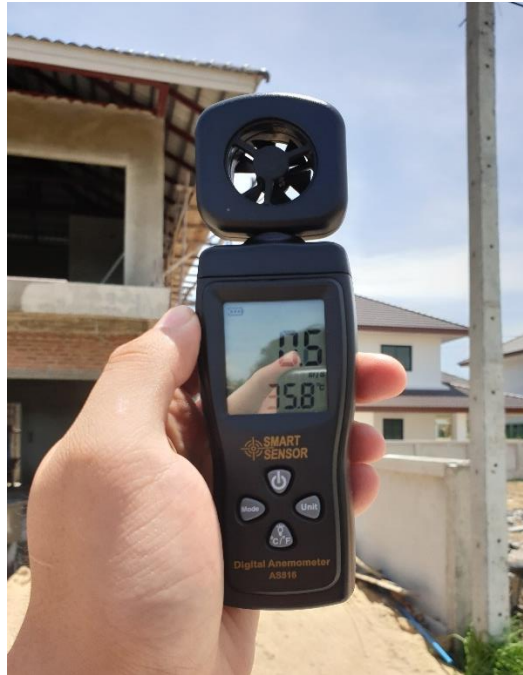
รูปที่ 5.17 รูปภาพแสดงขณะทำการวัดความเร็วลมและอุณหภูมิโดยรอบโครงการศึกษาระดับที่ 2
