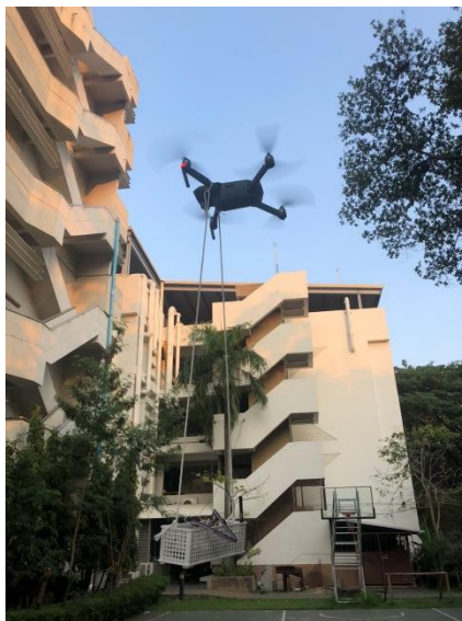
รูปที่ 4.1 รูปภาพแสดงโดรนที่ติดตั้งอุปกรณ์วัดปริมาณฝุ่นละออง อุปกรณ์วัดอุณหภูมิและความชื้น และอุปกรณ์กำหนดตำแหน่งบนพื้นโลก (GPS)
