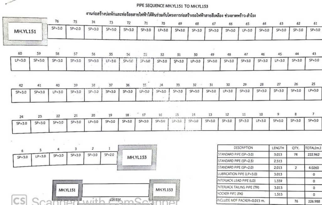
รูปที่ 4.9 แผนแสดงลำดับการดันท่อและตำแหน่งของท่อต้นที่มีการฉีตสารหล่อลื่น
