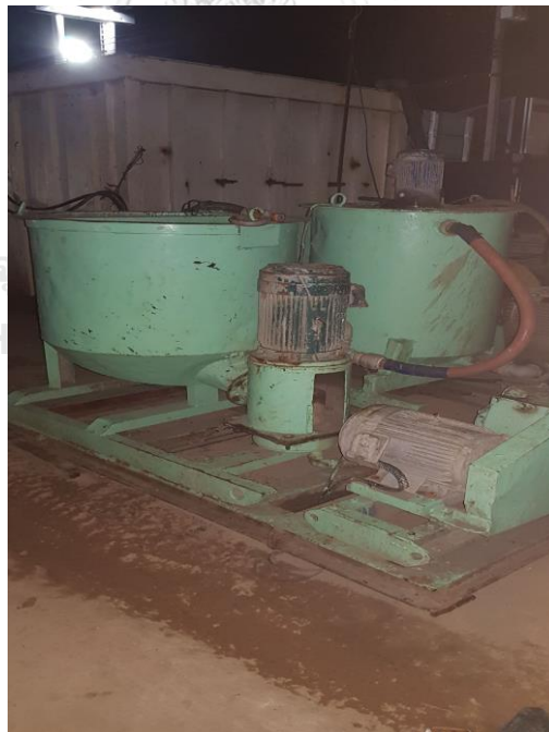
รูปที่ 4.11 ถังผสมและปั๊มสำหรับการฉีดสารหล่อลื่น
