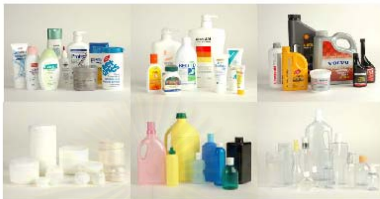
รูปที่ 55 ผลิตภัณฑ์จากการอัดรีดเป่าขึ้นรูป
