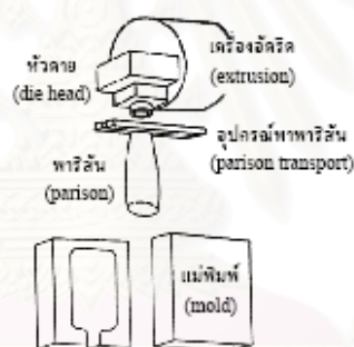
รูปที่ 7 ระบบการเคลื่อนย้ายพาริสันไปหาแม่พิมพ์ [3]
