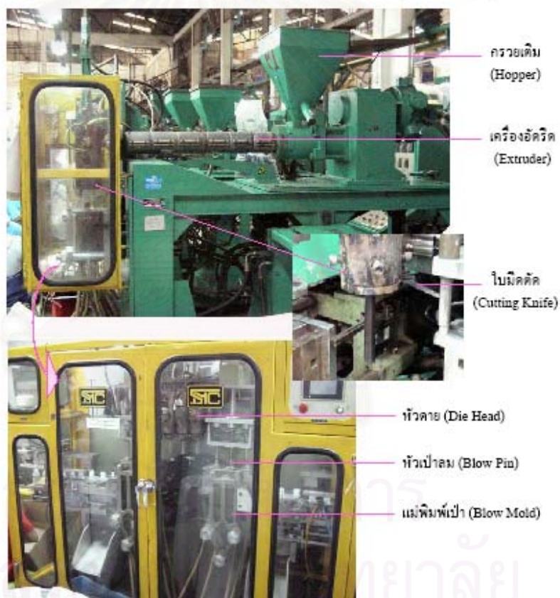
รูปที่ 1 ส่วนประกอบของเครื่องอัดรีดเป่าขึ้นรูป
