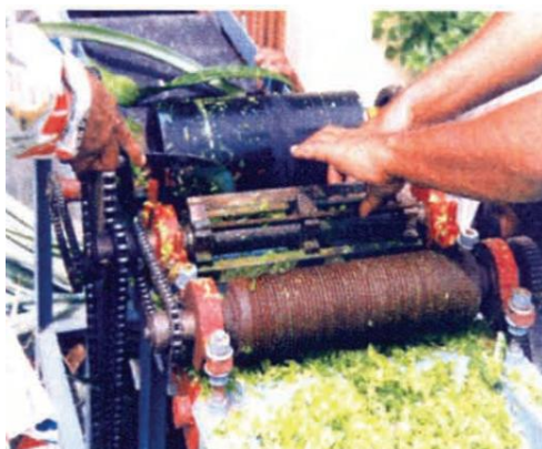
รูปที่ 2.2 การแยกเส้นใยสับประรดด้วยเครื่องจักรกล [13]
