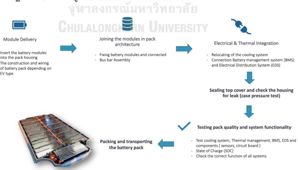
รูปที่ 16 ขั้นตอนการประกอบ Battery Pack
