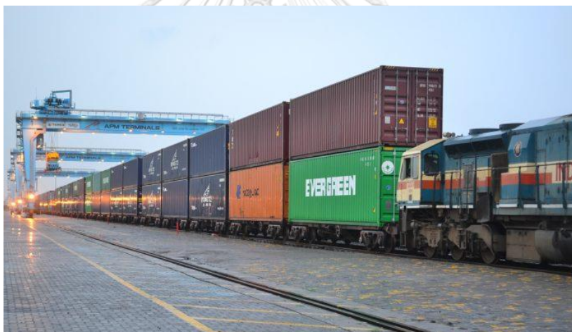
ภาพที่ 2.16 ตัวอย่างการขนส่งทางรถไฟแบบวางสองชั้น
