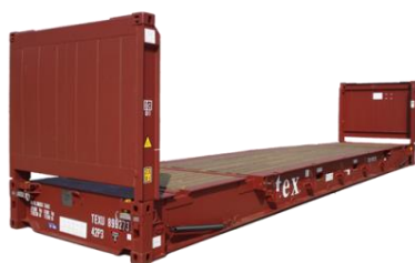
ภาพที่ 2.5 ตัวอย่างตู้คอนเทนเนอร์ชนิดแพลตฟอร์ม ที่มา: TEXTAINER
