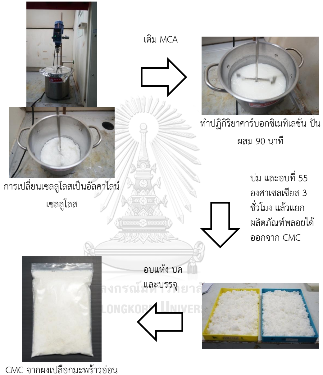
รูปที่ 3.6 ขั้นตอนการสังเคราะห์คาร์บอกซิเมทิลเซลลูโลสจากเปลือกมะพร้าวอ่อน
