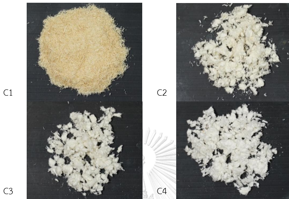
รูปที่ 4.4 ผงเปลือกมะพร้าวอ่อนแบบหยาบหลังการกำจัดลิกนินด้วย \text{NaClO}_2 ความเข้มข้น 1 เปอร์เซ็นต์ (น้ำหนักต่อปริมาตร)
