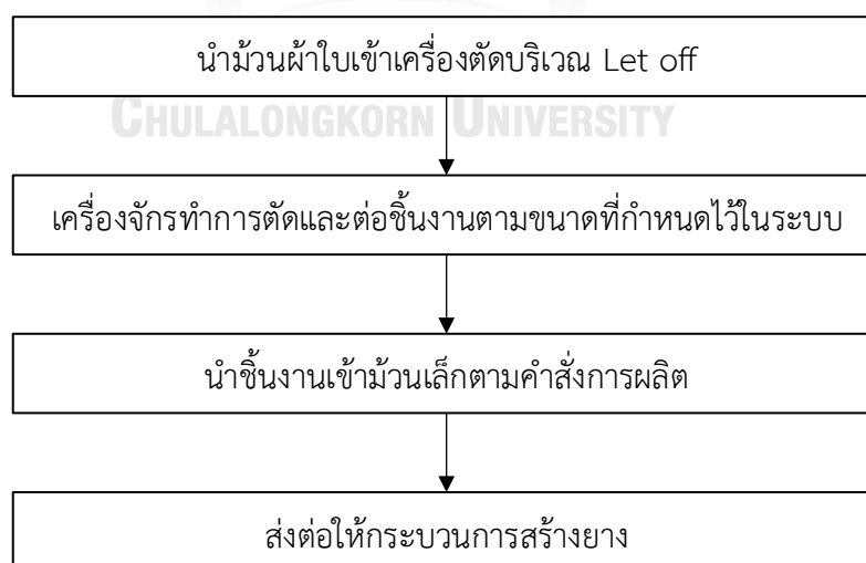
ภาพที่ 2-7 ขั้นตอนการเตรียมผ้าใบประกอบยางเครื่องบิน
