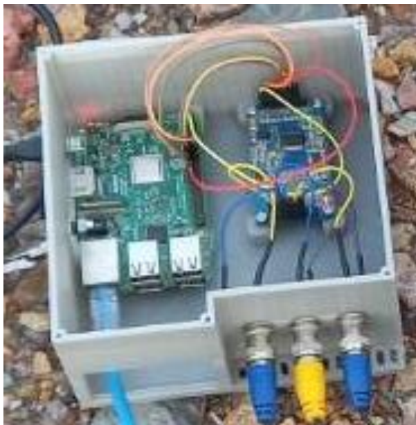
รูปที่ 3.3 อุปกรณ์ตรวจวัดคลื่นไหวสะเทือนในงานวิจัยนี้
