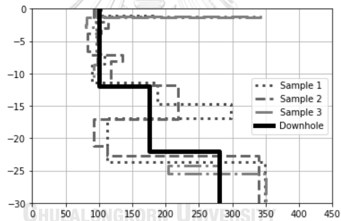
รูปที่ 4.11 ความเร็วคลื่นเฉือนของชั้นดินจากการคำนวณย้อนกลับด้วยวิธีการหาค่าที่เหมาะสมจากผลการตรวจวัดเส้นโค้งการกระจายตัวในพื้นที่จุฬาลงกรณ์มหาวิทยาลัย โดยใช้เครื่องมือการตรวจวัดที่ 6 เมตร ด้วยชุดโปรแกรม Dinver ซึ่งเปรียบเทียบกับความเร็วคลื่นเฉือนจากวิธีทดสอบดาวินโฮล
