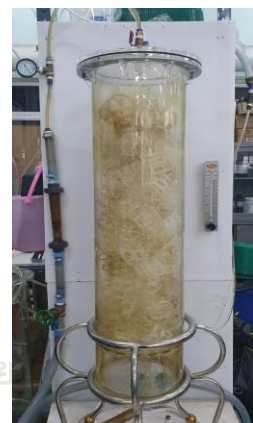
รูปที่ 21 แสดงแผนภาพการไหลของคอลัมน์แบบบรรจุตัวกลาง
