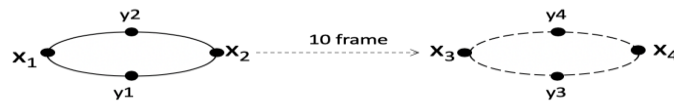
รูปที่ 28 ภาพจำลองของการเคลื่อนตัวของฟองอากาศและการคำนวณหาความเร็วฟอง
