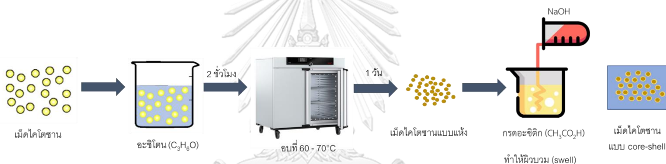
รูปที่ 16 แสดงขั้นตอนการผลิตเม็ดโคโตนแบบ core-shell
