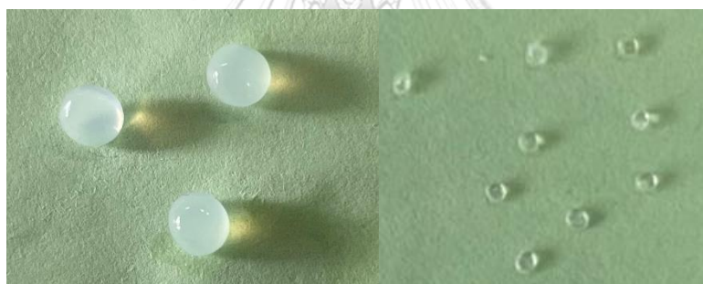
รูปที่ 30 แสดงเม็ดโคโตซานไฮโดรเจลและ core-shell
