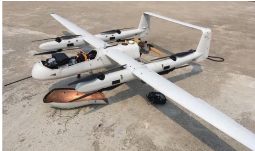
รูปที่ 18 การติดตั้งอุปกรณ์การสำรวจด้วยไลดาร์และกล้องถ่ายภาพ เข้ากับอากาศยานไร้คนขับรุ่น SUD VTOL-60
