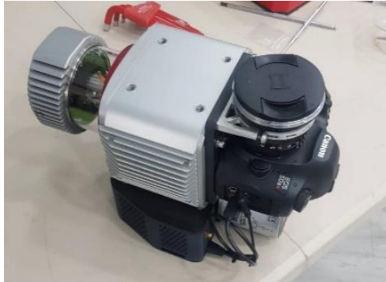
รูปที่ 13 ไลดาร์แบบ LiDAR Swiss Micro VUX CE และกล้องถ่ายภาพดิจิทัล DSLR
