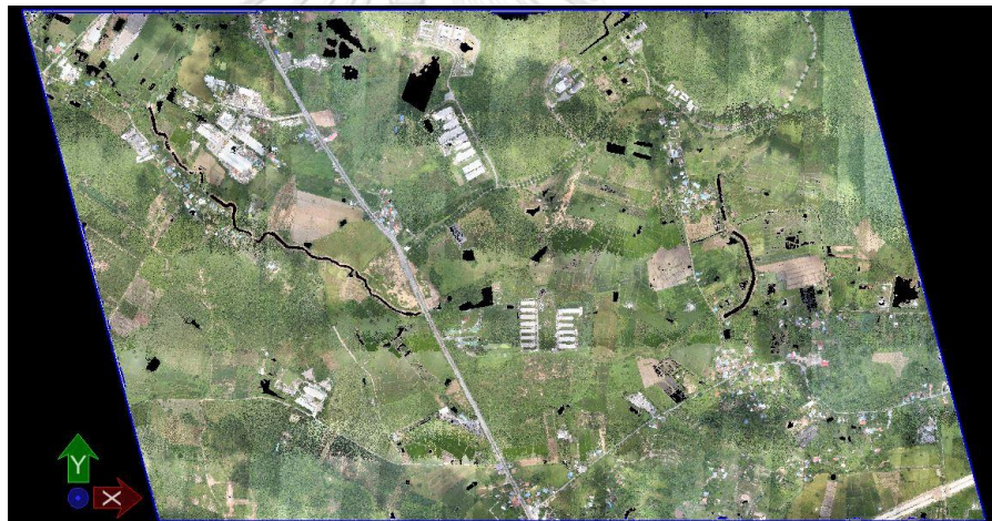
รูปที่ 14 ข้อมูลพอยต์คลาวด์ที่แสดงสีด้วยค่าสี RGB ในจุดภาพของภาพถ่ายทางอากาศ
