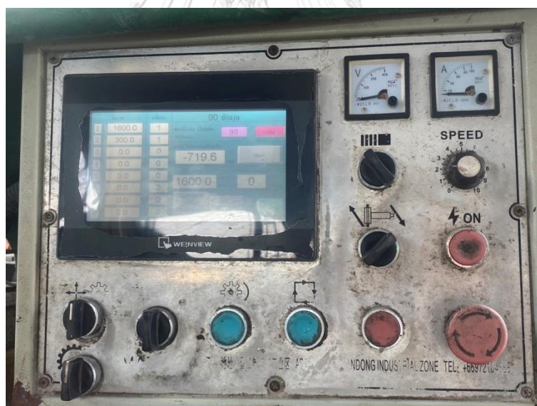
รูปที่ 21 หน้าจอการควบคุมความเร็วในการตัดของเครื่องตัดแผ่นหิน
