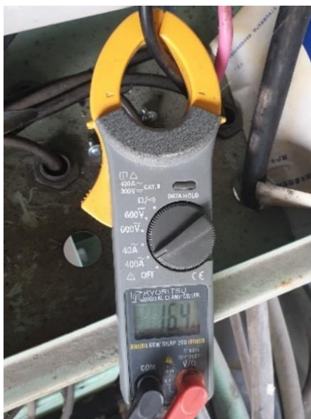
รูปที่ 24 ตัวอย่างของเครื่อง Digital Clamp Meter
