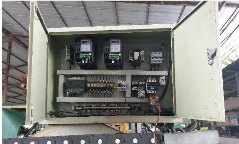
รูปที่ 26 การวัดกระแสไฟฟ้าขณะที่กำลังตัด
