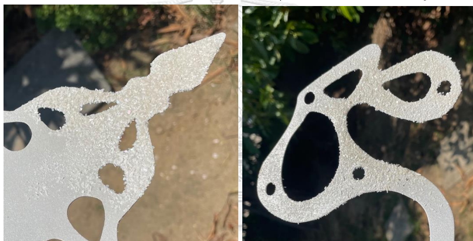
ภาพที่ 110 การทดลองสเปรย์เกล็ดปรอทขนาดใหญ่บนชิ้นส่วนอะลูมิเนียม
