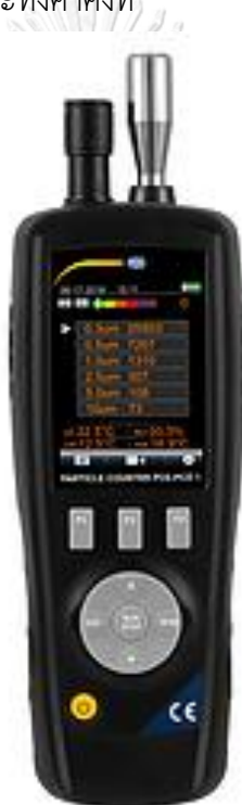
ภาพที่ 3 แสดงอุปกรณ์เครื่องวัดปริมาณอนุภาคฝอยละออง Portable particle counter (Particle Counter PCE-PCO 1®)
