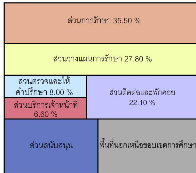
รูปที่ 4.19 ผังสัดส่วนพื้นที่ใช้สอยแต่ละส่วนของพื้นที่รังสีรักษาและมะเร็งวิทยา 3 (ชั้น B1 อาคารรัตนวิทยาพัฒนา)
