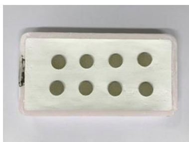
รูปที่ 3.3 ผงแก้วที่ผ่านการอัดขึ้นรูปเป็นเม็ด
