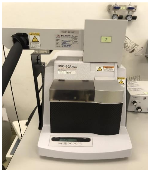
รูปที่ 3.8 เครื่องดีฟเฟอเรนเชียลแคลอริมิเตอร์
