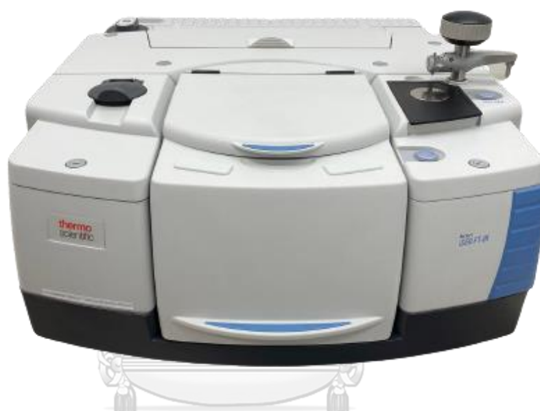
รูปที่ 3.3 เครื่องวิเคราะห์หาค่าองค์ประกอบทางโครงสร้างเคมีของสารโดยใช้ความยาวคลื่นช่วงอินฟราเรด รุ่น Nicolet 6700
