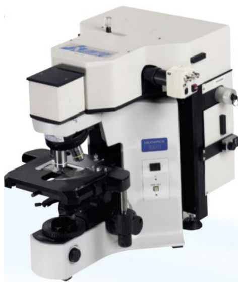
รูปที่ 3.4 เครื่องวิเคราะห์หาหมู่ฟังก์ชันฟูเรียร์ทรานสฟอร์มรามานสเปกโตรสโคปี รุ่น Olympus BX41
