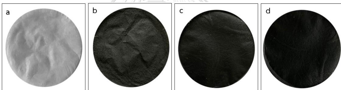
รูปที่ 4.12 ฟิล์มแบคทีเรียลเซลลูโลสและฟิล์มแบคทีเรียลเซลลูโลส/พอลิอะนิลีน ; (a) ฟิล์ม BC, (d) ฟิล์ม BC/PANi 1 : 0.25, (c) ฟิล์ม BC/PANi 1 : 0.5 และ (b) ฟิล์ม BC/PANi 1 : 1
