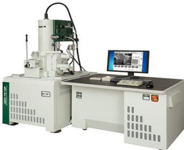
รูปที่ 3.6 กล้องจุลทรรศน์อิเล็กตรอนแบบส่องกราด รุ่น JSM-6480LV
