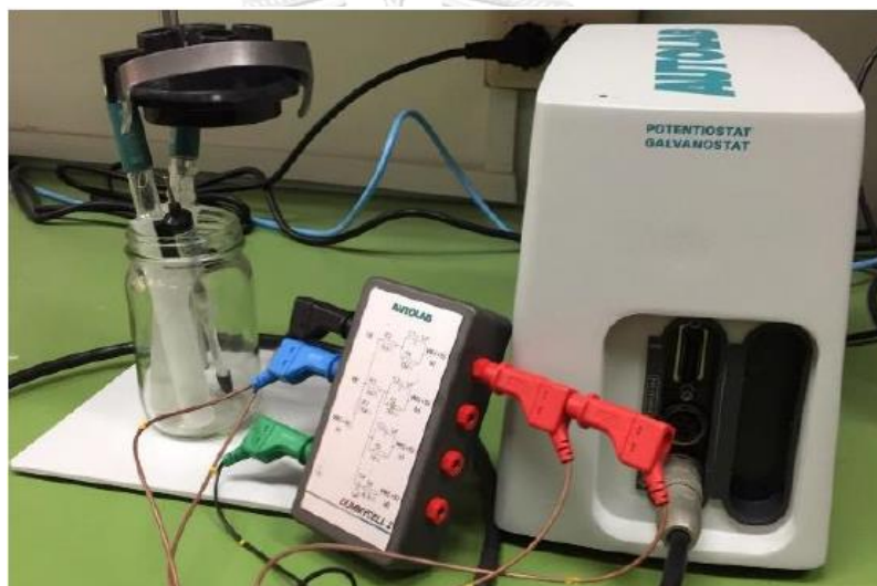
รูปที่ 3.9 เครื่องทดสอบสมบัติเคมีไฟฟ้า รุ่น PGSTAT204
