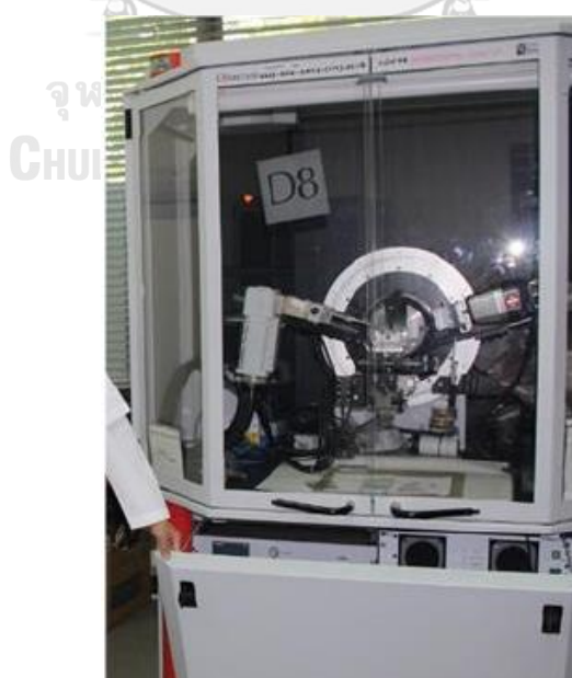
รูปที่ 3.5 เครื่องวิเคราะห์การเลี้ยวเบนรังสีเอกซ์ รุ่น D8 Advance
