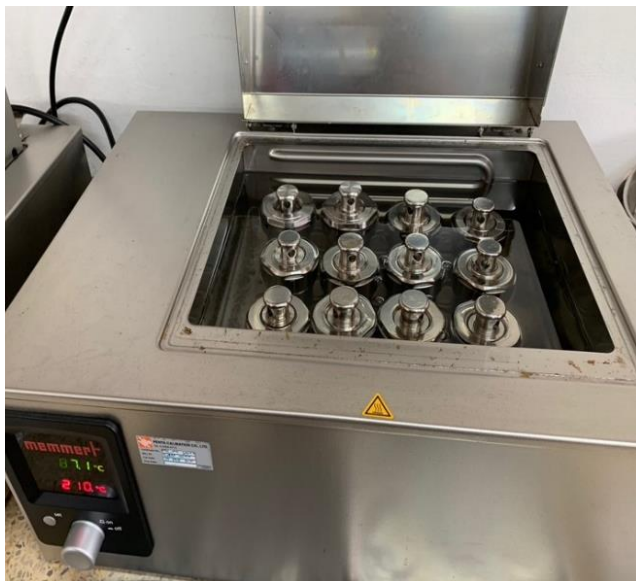
รูปที่ 3.2 การสังเคราะห์แมงกานีสไดออกไซด์ด้วยกระบวนการให้ความร้อนด้วยกระบวนการไฮโดรเทอร์มอลในอ่างน้ำมัน
