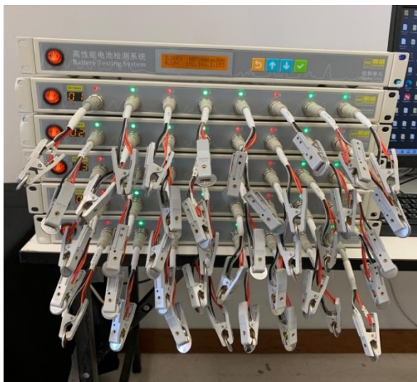
รูปที่ 3.7 รูปเครื่องทดสอบแบตเตอรี่หือ Neware BTS4000
