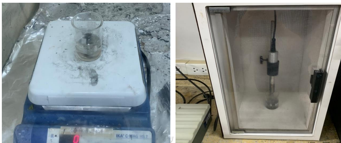
รูปที่ 3.3 การกวนและกระจายผงคาร์บอนด้วยเครื่องอัลตราโซนิกโพรบ
