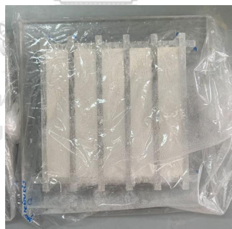
รูปที่ 3.4 ปั่นชิ้นงานในแม่แบบและคลุมด้วยถุงพลาสติกเพื่อป้องกันน้ำระเหยออกจากชิ้นงาน
