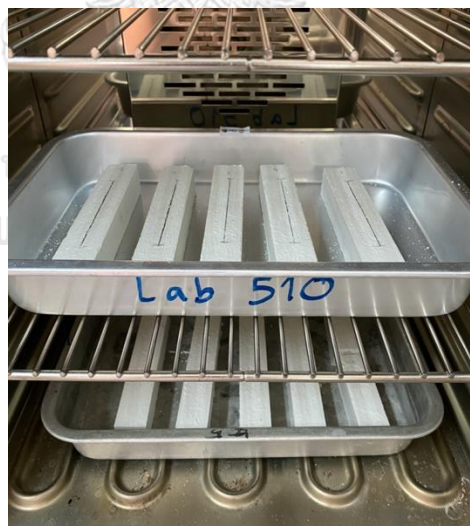
รูปที่ 3.6 อบชิ้นงานที่อุณหภูมิ 110 องศาเซลเซียส เป็นเวลา 24 ชั่วโมง
