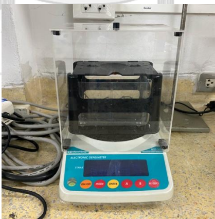
รูปที่ 3.9 เครื่องชั่งน้ำหนักชุดทดสอบความหนาแน่น
