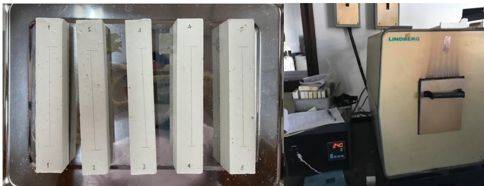
รูปที่ 3.7 ชิ้นงานหลังเผาที่อุณหภูมิ 1350 องศาเซลเซียส เป็นเวลา 4 ชั่วโมง ด้วยอัตราการเพิ่มอุณหภูมิ 5 องศาเซลเซียสต่อนาที
