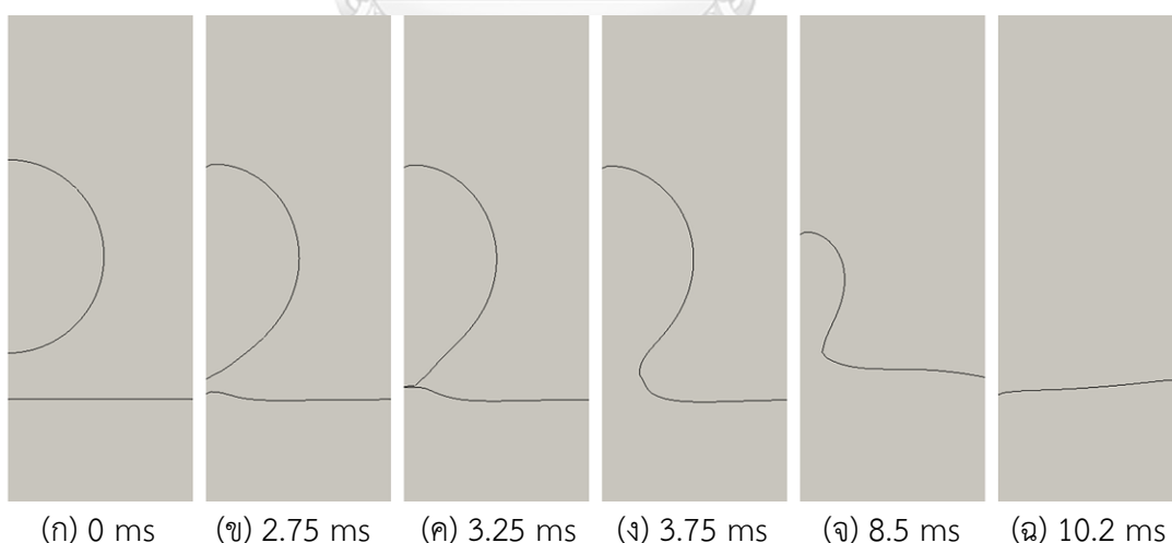
รูปที่ 6.11 ผลจำลองการรวมตัวของน้ำที่ไม่มีประจุในน้ำมันแร่ที่สนามไฟฟ้า 3.0 kV/cm
