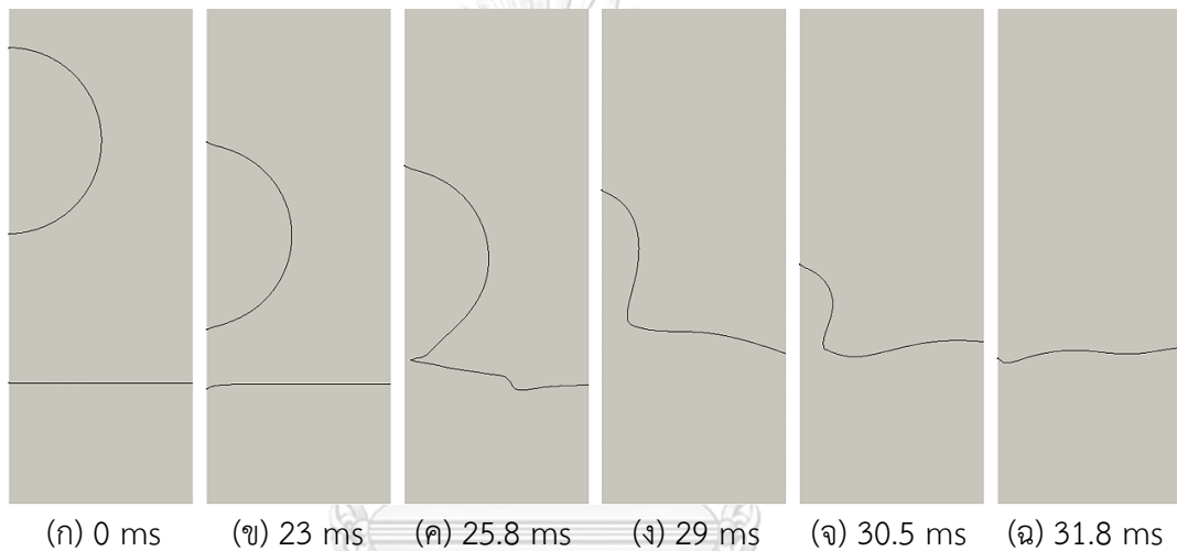
รูปที่ 6.20 ผลจำลองการรวมตัวของน้ำที่มีประจุในน้ำมันแร่ที่สนามไฟฟ้า 1.0 kV/cm
