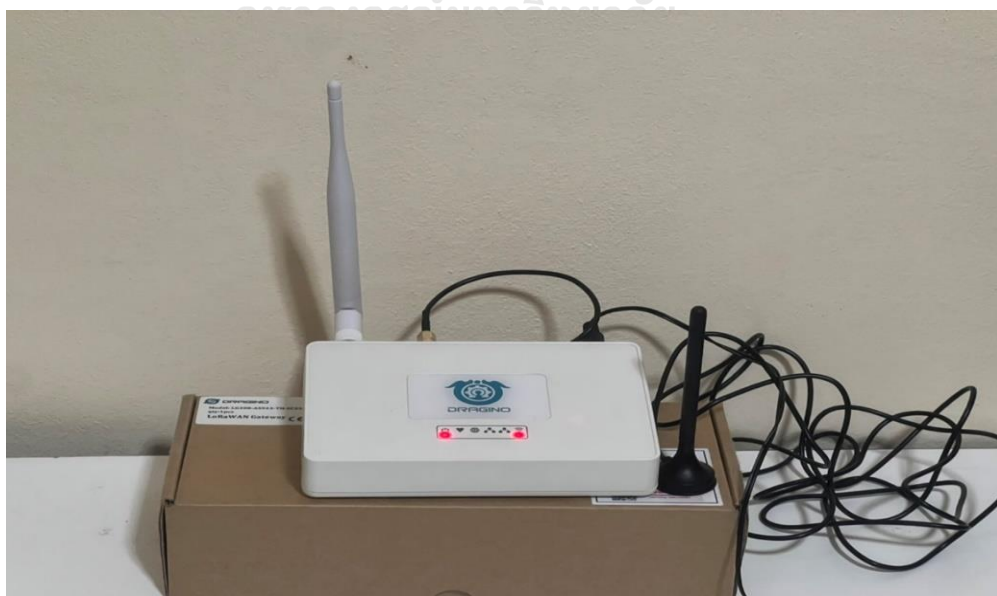
รูปที่ 39 Dragino LoRaWAN Gateway LG308-AS923-TH-EC25 รุ่น 4G
