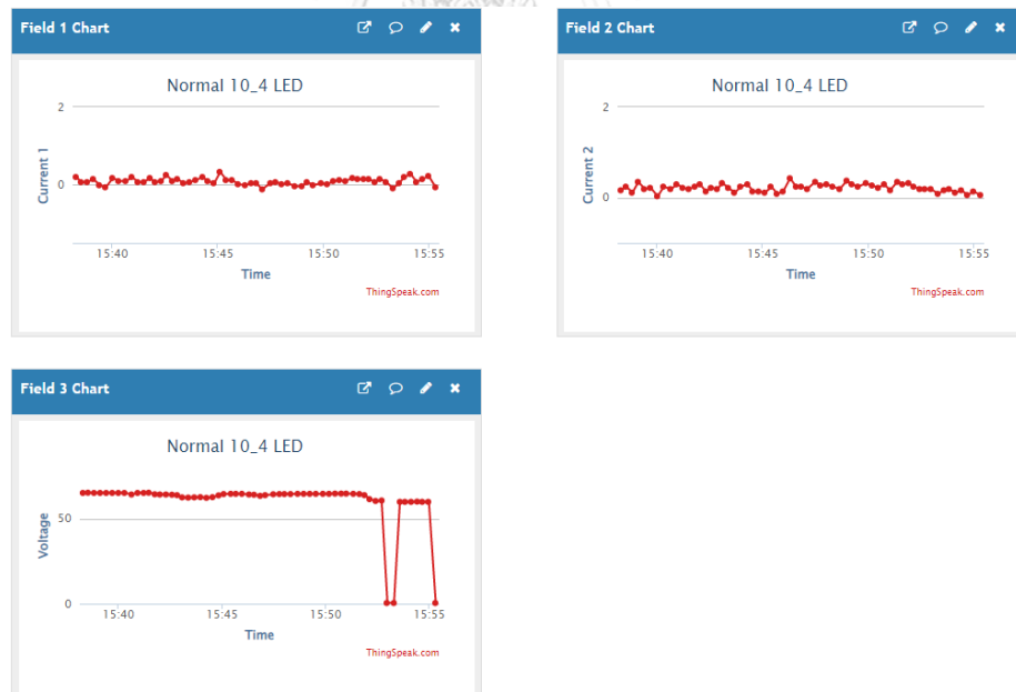
รูปที่ 41 ตัวอย่างกราฟของกระแสไฟฟ้าและแรงดันไฟฟ้าที่แสดงบน IoT Analytics-ThingSpeak Internet of Things
