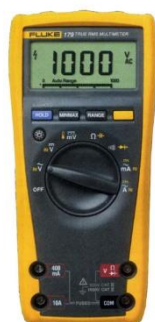
(ก) ดิจิตอลมัลติมิเตอร์ FLUKE รุ่น 179 (ข) เครื่องออสซิลโลสโคป Tektronix รุ่น TBS1022
