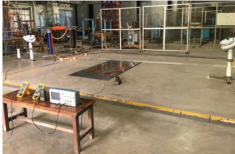
รูปที่ 4.2 การติดตั้งอุปกรณ์วัดความหนาแน่นกระแสไอออนในห้องทดสอบ
