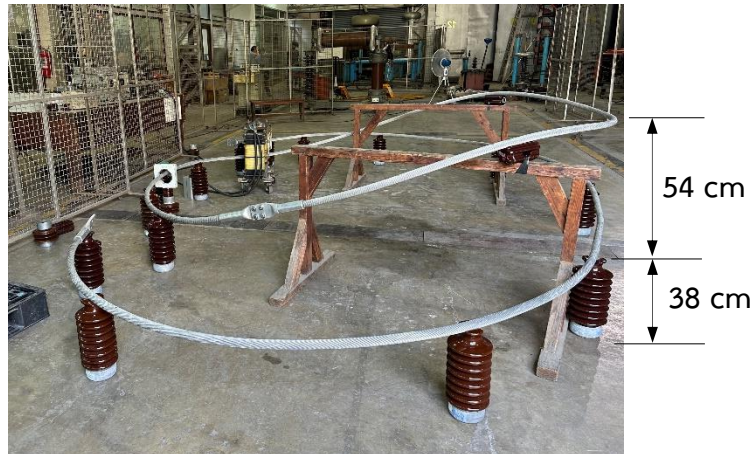
รูปที่ 4.12 การติดตั้งอุปกรณ์กรณีสายตัวนำ 1 เส้น ติดตั้งสายตัวนำต่อลงกราวด์ด้านล่าง
