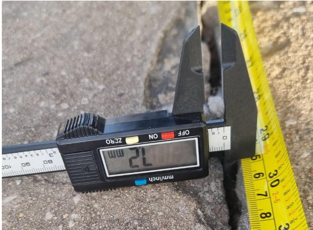
รูปที่ 148 การวัดขนาดความกว้างรอยต่อทางเท้าบริเวณรอยต่อที่ 2 เสาคอม่อที่ 3
