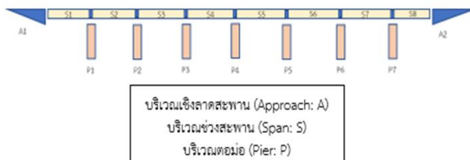
รูปที่ 45 จำนวนบริเวณต่าง ๆ ของสะพานธนรัชต์
