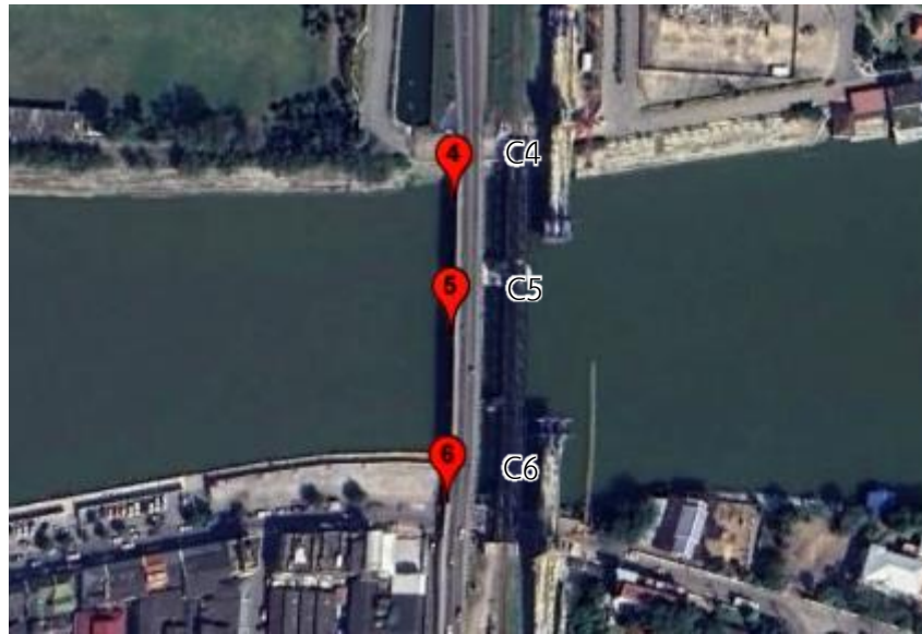
รูปที่ 33 ตำแหน่งจุดอ้างอิงที่ใช้ในการรังวัดส่วนบนของสะพาน
