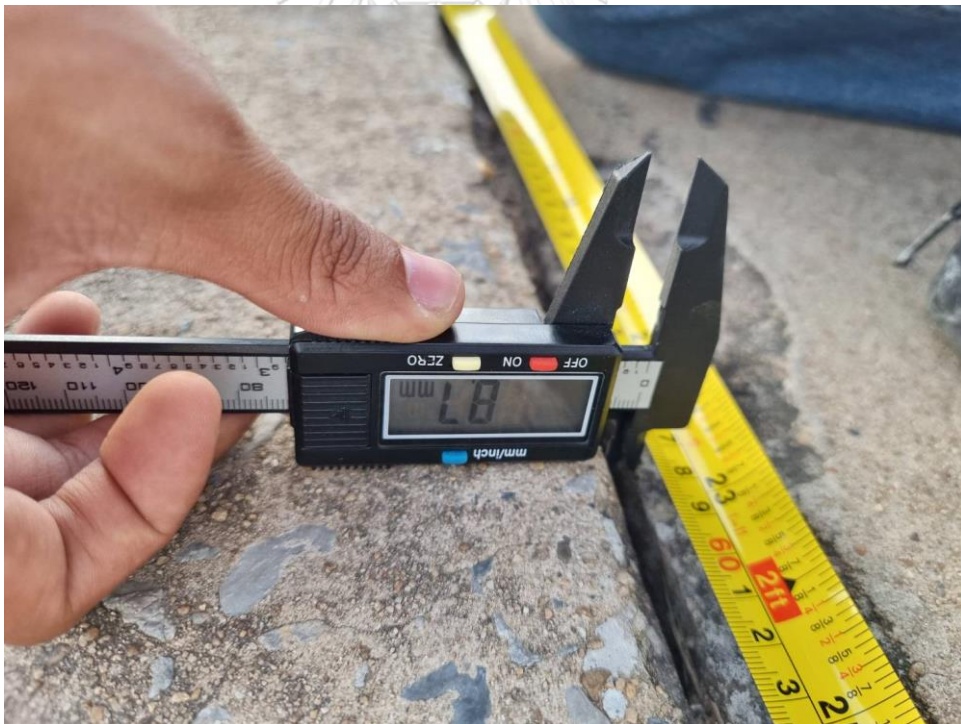
รูปที่ 159 การวัดขนาดความกว้างรอยต่อทางเท้าบริเวณรอยต่อที่ 1 เสาคอมม่อที่ 1
