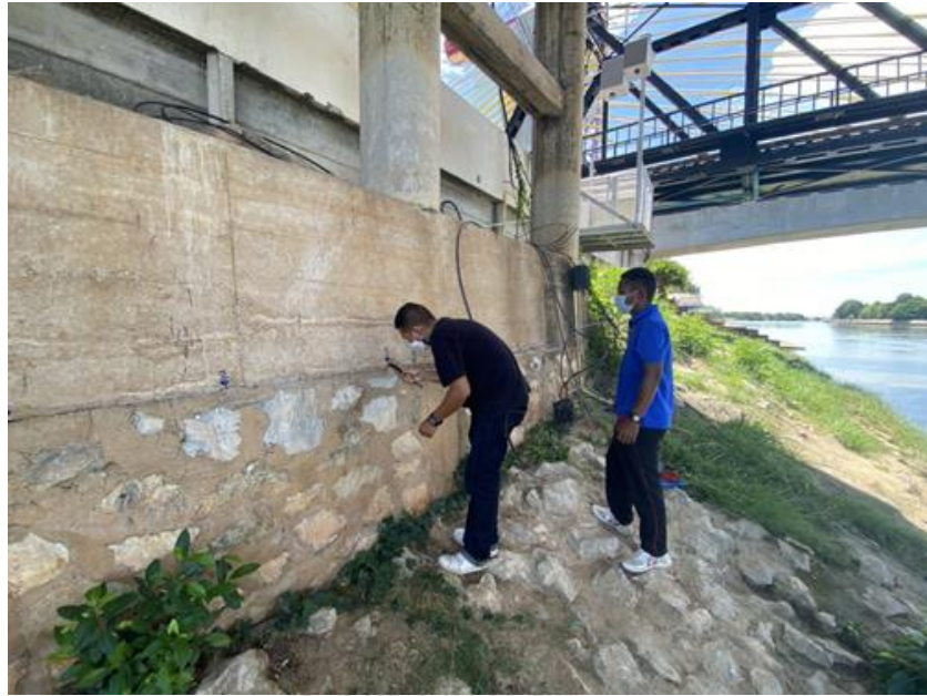
รูปที่ 46 การวัดขนาดความเสียหายเสาตอม่อตัวที่ 1
