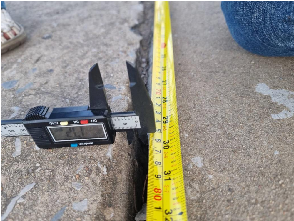
รูปที่ 152 การวัดขนาดความกว้างรอยต่อทางเท้าบริเวณรอยต่อที่ 2 เสาคอม่อที่ 7
