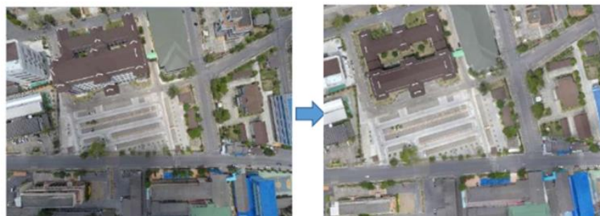
รูปที่ 15 ภาพตัวอย่างเปรียบเทียบ Orthophoto กับ True Orthophoto [25]
