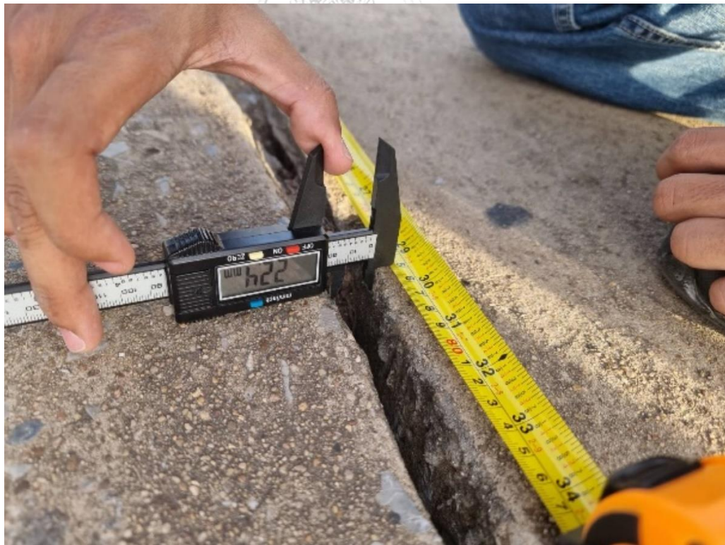
รูปที่ 151 การวัดขนาดความกว้างรอยต่อทางเท้าบริเวณรอยต่อที่ 2 เสาต่อม่อที่ 6
