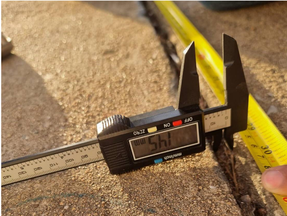
รูปที่ 156 การวัดขนาดความกว้างรอยต่อทางเท้าบริเวณรอยต่อที่ 1 เสาดม่อที่ 4
