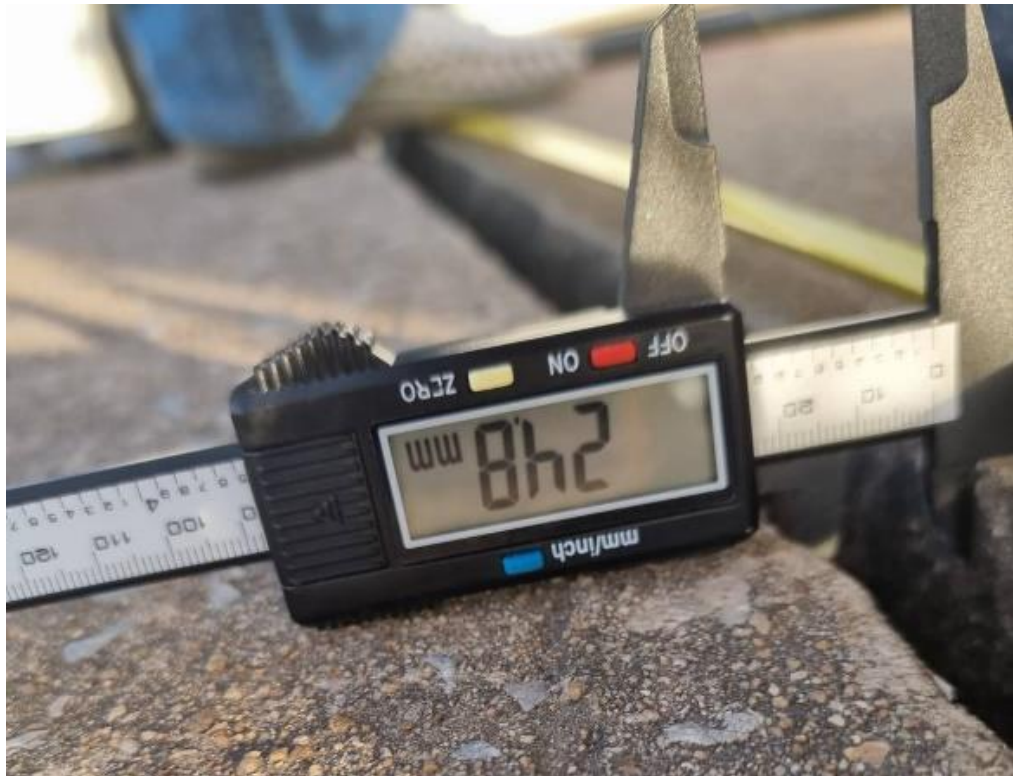
รูปที่ 150 การวัดขนาดความกว้างรอยต่อทางเท้าบริเวณรอยต่อที่ 2 เสาต่อม่อที่ 5
