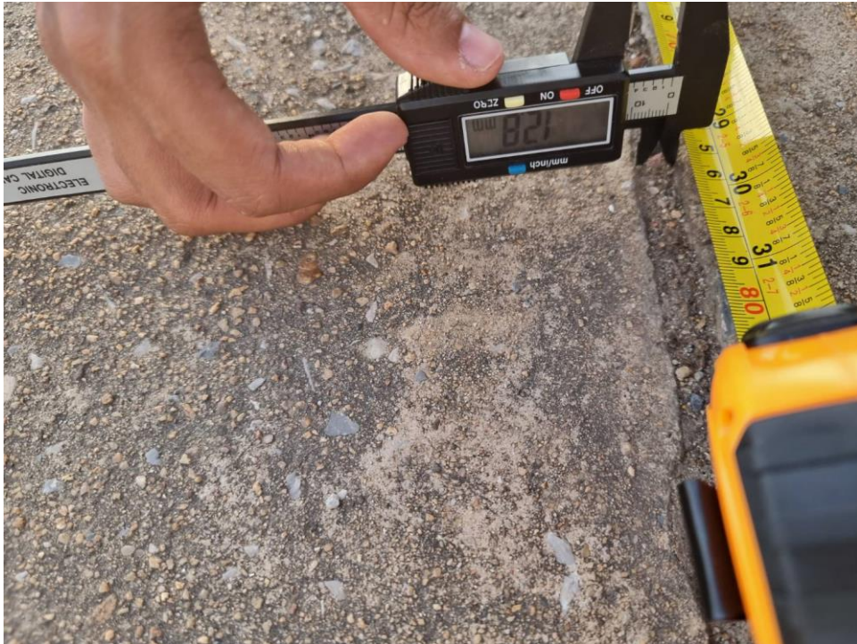
รูปที่ 158 การวัดขนาดความกว้างรอยต่อทางเท้าบริเวณรอยต่อที่ 1 เสาคอมม่อที่ 2
