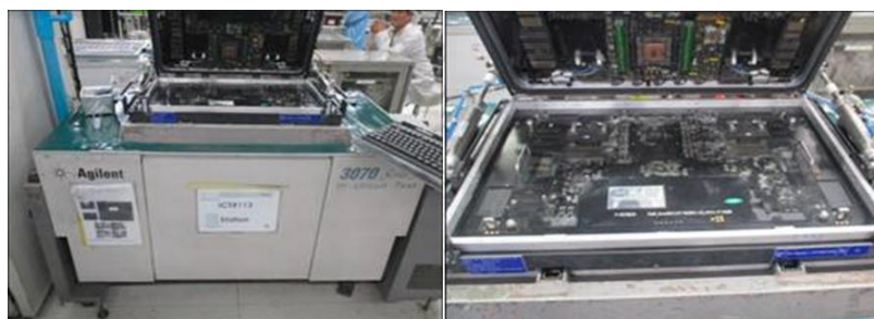
รูปที่ 6.9 ฟิวเจอร์ที่ใช้ในกระบวนการทดสอบทางไฟฟ้า
