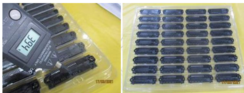
รูปที่ 5.18 แสดงการวัดแรงดันไฟฟ้าบนตัวชิ้นส่วน Power connector (ขณะชิ้นงานอยู่ในสภาพ) ผลการวัดที่ได้
