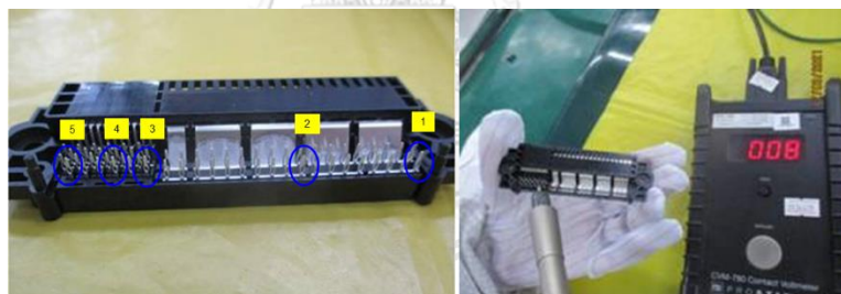
รูปที่ 5.21 แสดงการวัดแรงดันไฟฟ้าบนตัวชิ้นส่วน Power connector (ขณะหยิบออกจากถาด) ผลการวัดที่ได้
