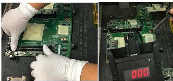
รูปที่ 6.2 การประกอบ Dimm connector และวัตไฟฟ้าสถิตบนแผงวงจร
