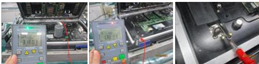
รูปที่ 6.11 การวัดค่าความต้านทานของฟิวเจอร์ทดสอบ
