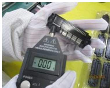
รูปที่ 5.20 แสดงการวัดแรงดันไฟฟ้าบนตัวชิ้นส่วน Power connector (ขณะหยิบออกจากถาด) ผลการวัดที่ได้
