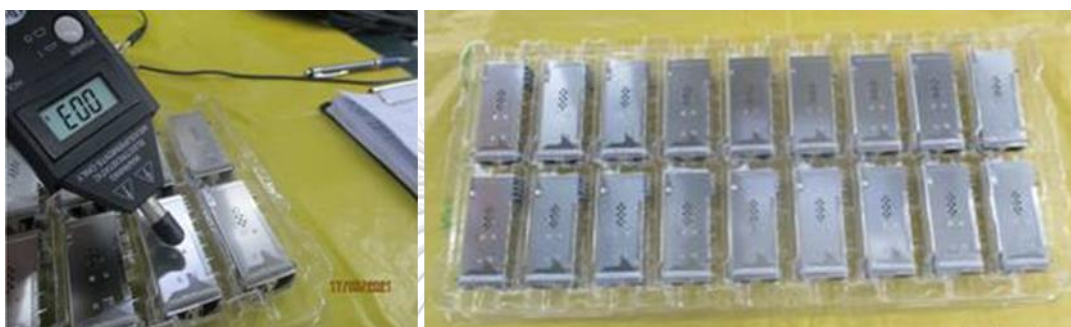
รูปที่ 5.14 แสดงการวัดแรงดันไฟฟ้าบนตัวชิ้นส่วน SFP connector (ขณะชิ้นงานอยู่ในถาด) ผลการวัดที่ได้
