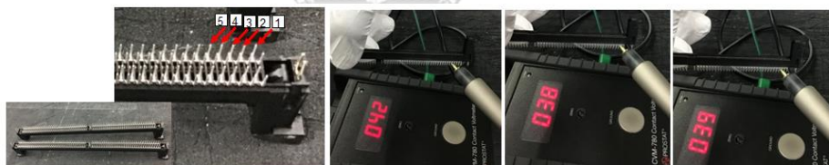
รูปที่ 5.4 แสดงลักษณะการวัดแรงดันไฟฟ้าบนขาอุปกรณ์ Dimm connector
