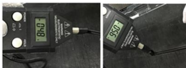
รูปที่ 5.3 แสดงลักษณะการวัด static field บนตัวอุปกรณ์ Dimm connector
