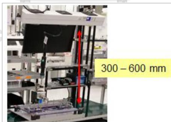
รูปที่ 6.5 ตำแหน่งของพัดลมสลายประจุไฟฟ้าที่โต๊ะทำงาน
