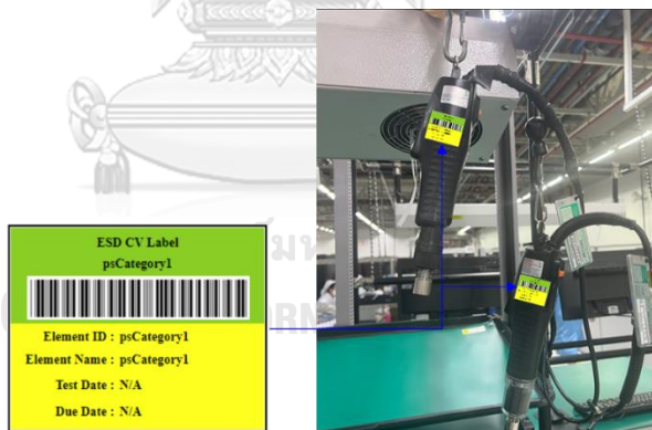
รูปที่ 7.4 ตัวอย่างการติดสติ๊กเกอร์ ESD CV
